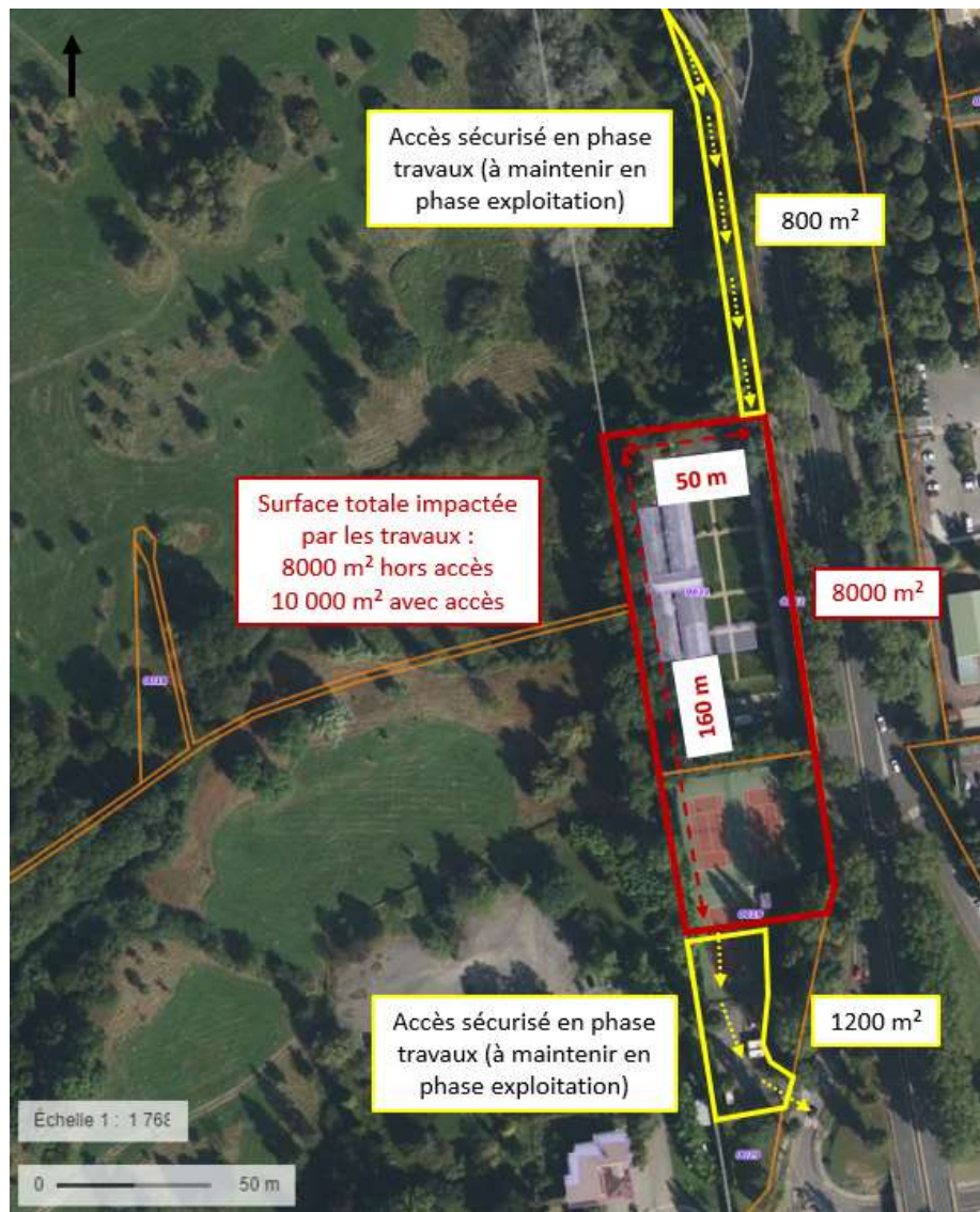
Figure 15 – Accès plateforme de forage premier et deuxième doublet
