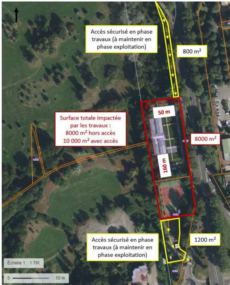
Figure 9 – Accès plateforme de forage premier et deuxième doublet
